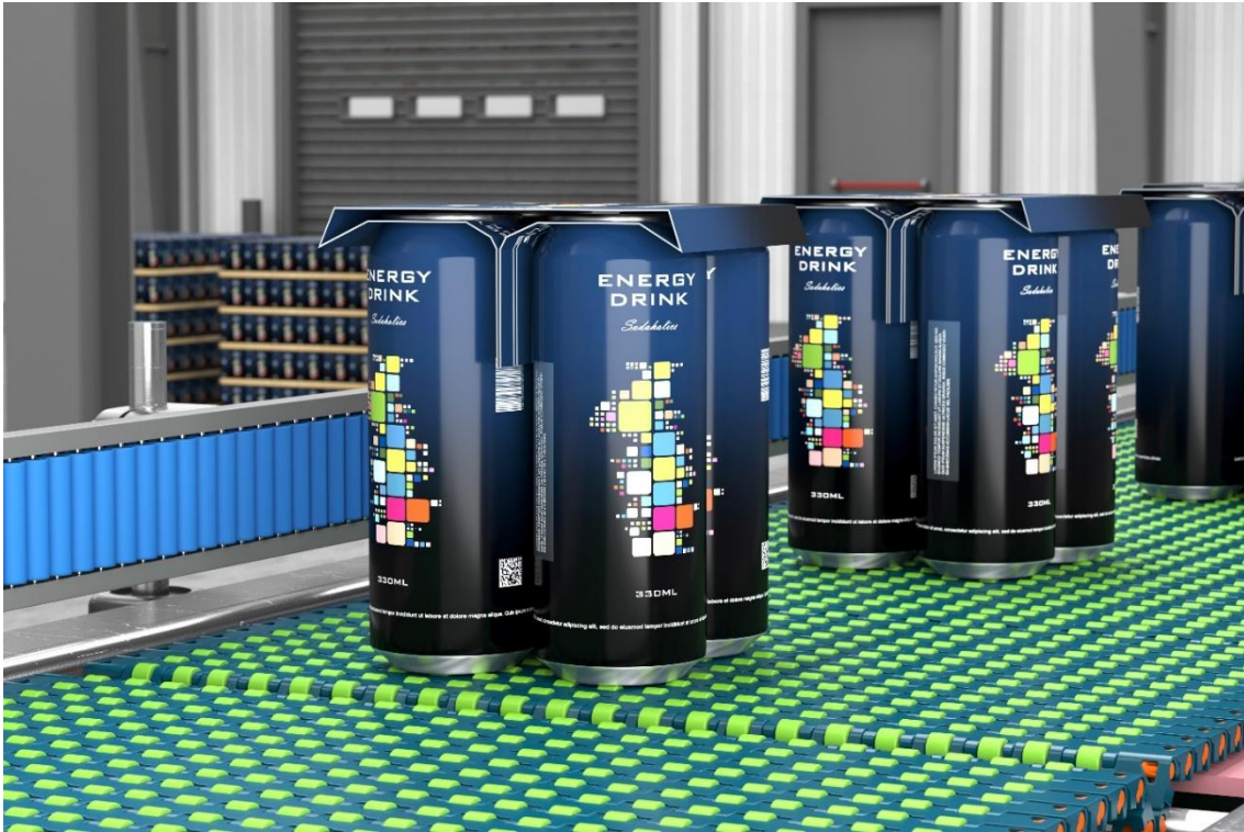
Bild 1: Aufsätze aus Pappe sind zwar umweltfreundlicher und im Regal effizienter als herkömmliche Schrupffolienverpackungen, aber auch eine Herausforderung für die Produktionslinie.
