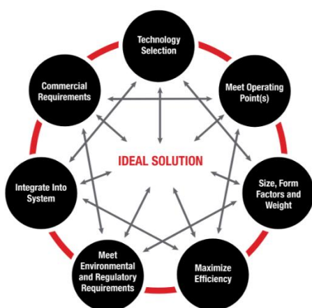
Image 2 : Trouver la solution de motorisation idéale pour le robot exige un arbitrage entre des considérations interdépendantes.
