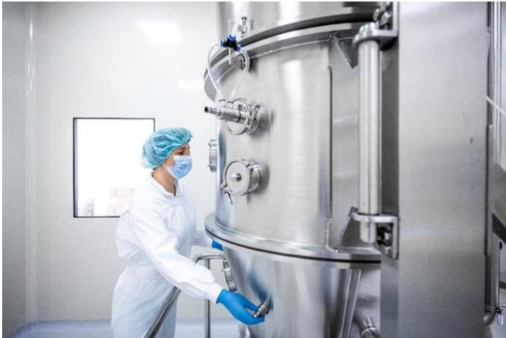
**Bild 1:** Die hocheffiziente Methode der Wirbelschichttrocknung spielt eine grundlegende Rolle in diversen Fertigungssektoren wie der Pharma-, Chemie-, Lebensmittel- und Getränkeindustrie. (iStock-1417391938)
