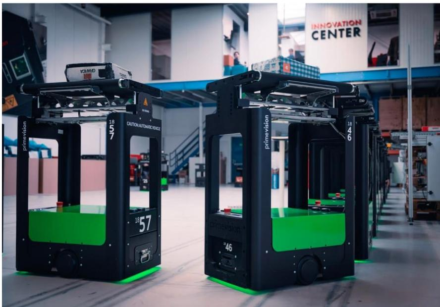
**Bild 2:** Die Roboter von Prime Vision haben eine Tragfähigkeit von 35 kg und eine Ladefläche von 50 x 70 cm für den Transport verschiedenster Kartons.
