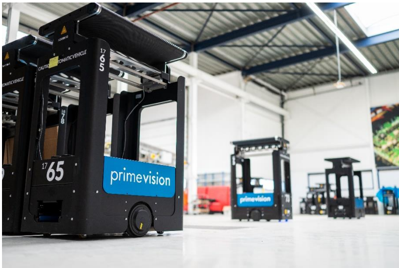
Bild 3: Roboter können völlig flexibel für mehr oder weniger Fahrzeuge sortieren – ohne die Einschränkungen einer festen Infrastruktur.
