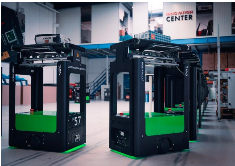
Bild 2: Roboter können 100 bis 10.000 Pakete pro Tag bearbeiten, wobei sich die Roboterflotte nach Bedarf erweitern oder reduzieren lässt.
