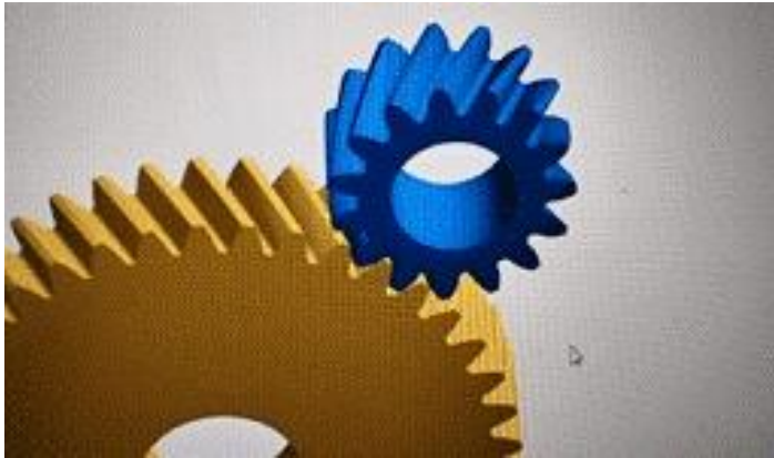
Image 1 : La conception d'un engrenage hélicoïdal garantit que les paires de dents entrent progressivement en contact et s'engagent le long d'un profil en hélice.
