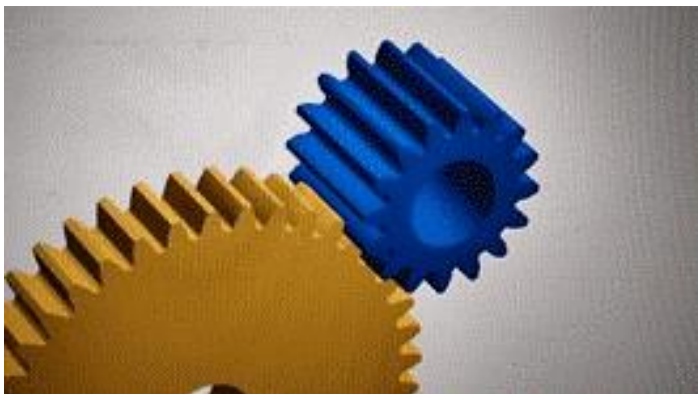
Image 2 : Le contact des engrenages à dentures droites a lieu simultanément sur toute la largeur de la face des dents, qui sont positionnées parallèlement à l'axe de rotation des pignons.
