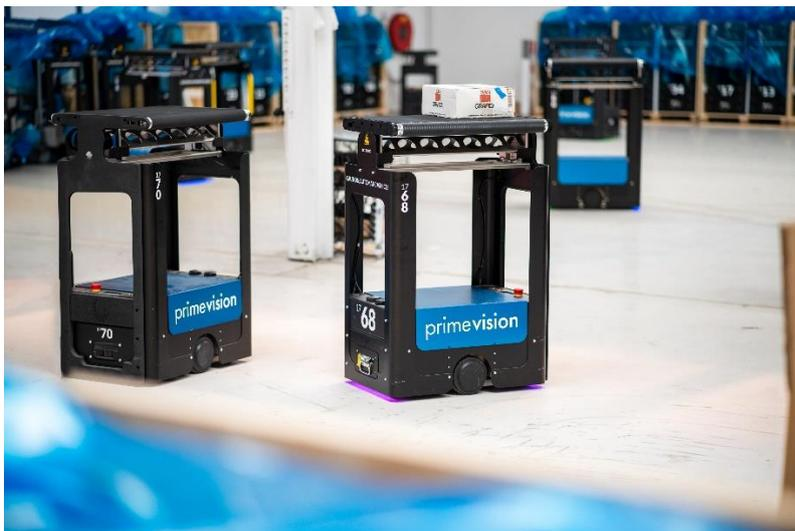
**Bild 2:** Prime Vision-Roboter navigieren mithilfe einer Kamera und Sensoren in einem vordefinierten Bereich. Wenn der Roboter ein Hindernis erkennt, hält er automatisch an.
