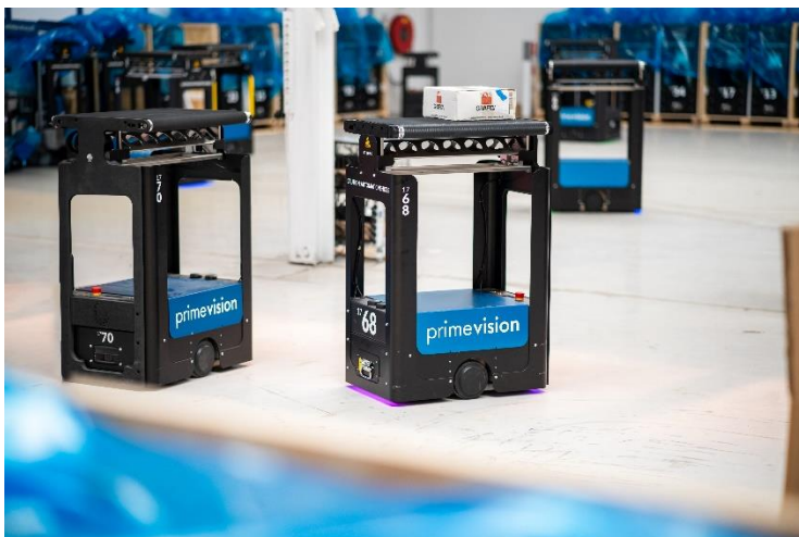
Beeld 2: Prime Vision-robots navigeren binnen een vooraf gedefinieerd gebied via een camera en sensoren. Als een robot een obstakel opmerkt, stopt hij automatisch.
