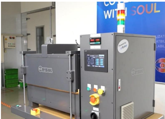
Immagine 2: Orisol ha visto la sua serie OFA240 di sistema di macchine di lampeggio per permettere l'unione della tomaia alla suola come la candidata ideale per beneficiare dei principi della tecnologia TSN (© Orisol)
