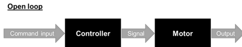
Image 2: Offene Regelkreissysteme in Gleichstrommotoren
