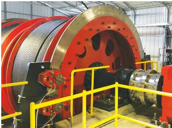
**Bild 2:** Kupferminen sind auf maximal zuverlässige Trommelfördermaschinen angewiesen, mit denen Gerät und Bergleute transportiert werden.
