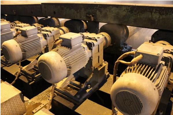
**Image 2:** La solution de retrofit "plug and play" du motoréducteur comprend un accouplement et une embase d'adaptation standardisés
