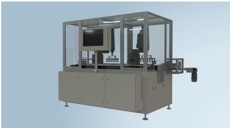
**Bild 2:** Der Automat von Optimal besteht aus Produktträgern („Pucks“), SCARA-Robotern sowie einer Förderanlage und entlastet das Bedienpersonal von repetitiven Aufgaben.
