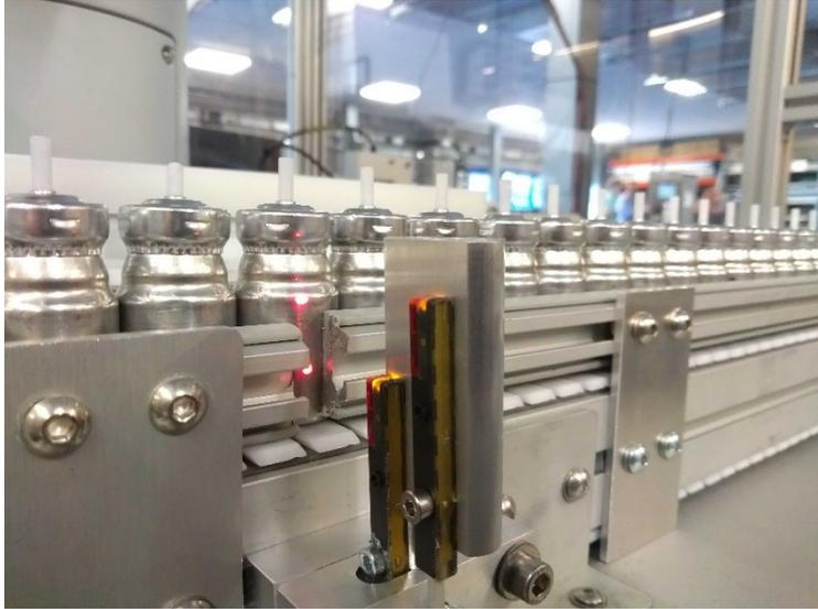
**Bild 1:** Durch das iPass™ für MDI, ein System zur Erkennung kleinster Aerosol-Austrittsmengen, lassen sich einzelne fehlerhafte Druckgasbehälter in einem kontinuierlichen Prozess zuverlässig identifizieren und aussondern.
