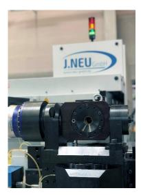
Image 3: Das Material wird durch eine Biegematrize gedrückt, und durch eine dynamisch gesteuerte Bewegung um sechs Achsen können nahtlose Geometrien geformt werden. [Quelle: Mitsubishi Electric Europe B.V., Jörg Neu GmbH]
