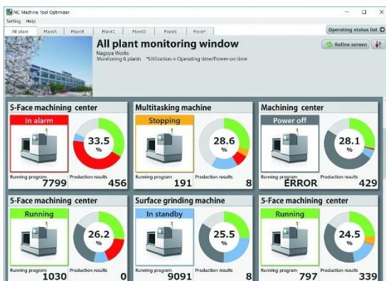
**Image 2:** L'N'NC Machine Tool Optimizer di Mitsubishi Electric è in grado di interpretare le informazioni ricevute diverse macchine utensili per offrire una piattaforma intuitiva per la visualizzazione e il monitoraggio dei processi. [Fonte: Mitsubishi Electric Europe B.V.]
