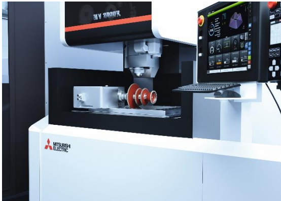
Image 1: EDM-Dress – die perfekte Technologie für einen optimierten Schleifprozess mit einem hochpräzisen Allzweck-Drahterodiersystem. [Quelle: Mitsubishi Electric Europe B.V.]
