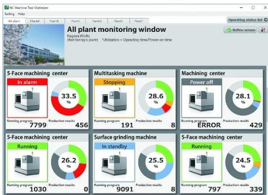
**Image 2:** Der NC Machine Tool Optimizer von Mitsubishi Electric kann Informationen von mehreren Werkzeugmaschinen interpretieren und so eine intuitive Prozessvisualisierung und -überwachung ermöglichen. [Quelle: Mitsubishi Electric Europe B.V.]
